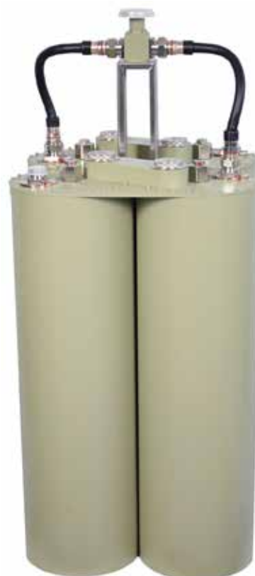
Modèle deux cavités Espace entre fréquences : 1,2 MHz - 2,5 kW (2x1,2 kW) "EIA" OUT - "7/16" IN (2x)
