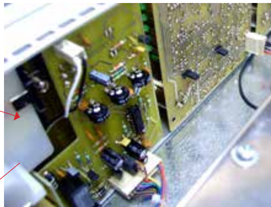
Carte audio avec filtre et limiteur digital
